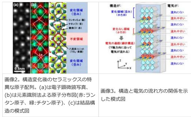
画像2. 構造変化後のセラミックスの特異な原子配列。(a)は電子顕微鏡写真、(b)は元素識別法による原子分布図(赤:ランタン原子、緑:チタン原子)、(c)は結晶構造の模式図
