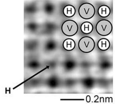
初めて撮影された水素化バナジウム。水素(H)とバナジウム(V)の原子が規則的に並んでいるのが識別できる。枠外のスケールは0.2ナノメートル=1000万分の2ミリ(幾原雄一東京大教授提供)
